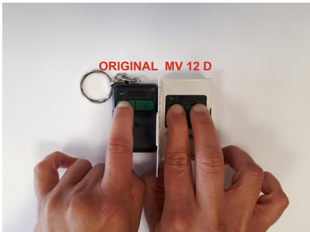
2º.- Sin soltar ambos canales, pulsar cualquier canal del emisor Original. El led del emisor MASTERcode, modelo MV 12 D parpadeará, indicando que el emisor ha sido grabado correctamente.
