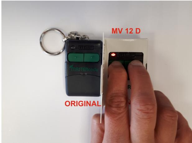
1º.- Junte en paralelo ambos emisores. Pulse y mantenga pulsados los dos canales del emisor MASTERcode modelo MV 12 D, en el que va a copiar la información del emisor Original. El led se enciende y tras un segundo se apagará.
