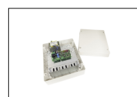
B71/PBX24/BOX Inverter híbrido versión "Network Assisted" para la alimentación de la automatización, con función de carga de baterías a través de la conexión a los paneles solares o red fija, para alimentar los controladores digitales de 24V DC con tensión de red de 230V AC.
