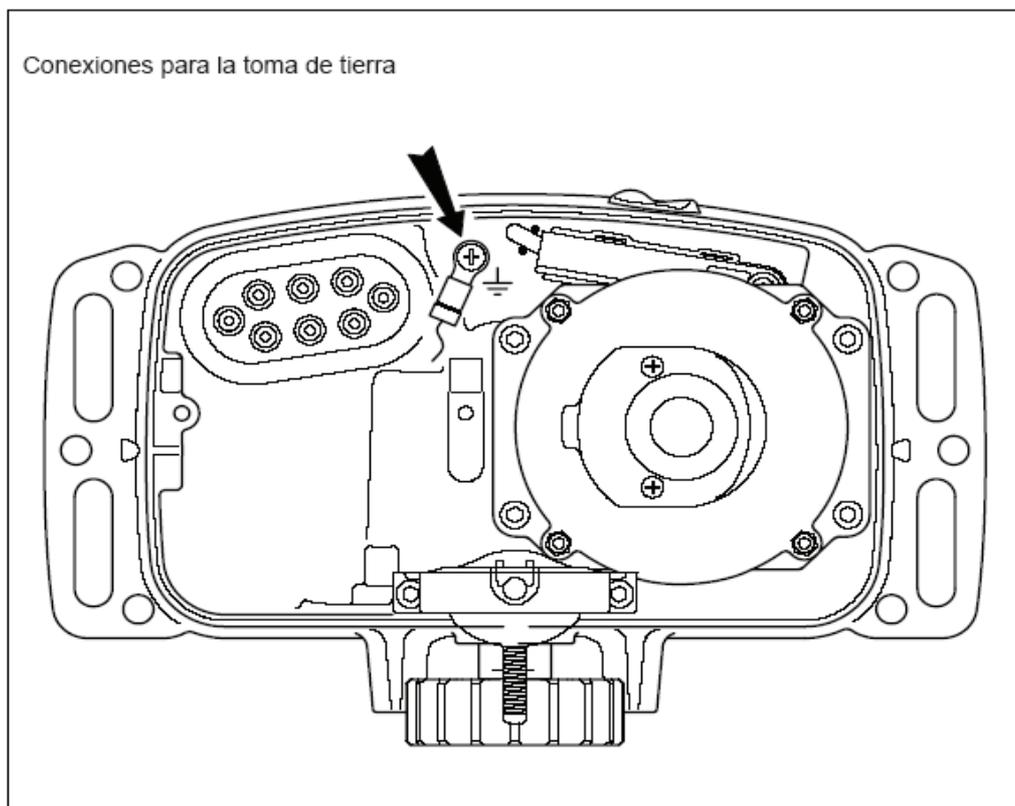
Para la puesta en marcha del motor reductor, es obligatorio realizar la conexión de tierra en la posición indicada en la figura 1
